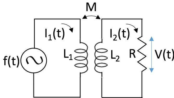
Si alimenti il primario con un generatore  $f(t) = f_0 \sin \omega t$  al quale corrisponde il fasore  $\bar{f} = f_0$ .
