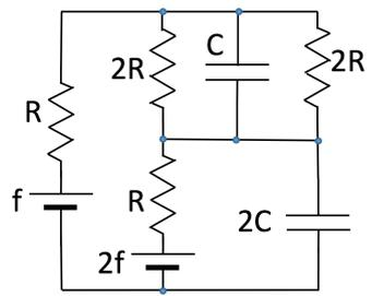
6.5) Calcolare quanta energia è accumulata e quanta potenza viene dissipata nel circuito in figura in cui  $f = 10 \text{ V}$ ,  $R = 100 \Omega$ ,  $C = 100 \text{ nF}$
