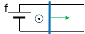
{ricavare nell'ordine: la corrente della maglia, la forza (Il Laplace) agente sulla sbarretta, l'espressione della velocità in funzione del tempo ( $a = dv/dt$ )}
