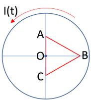
10.24) L'avvolgimento in aria di un solenoide ideale costituito da  $n$  spire/metro è percorso, a partire da  $t = 0$ , dalla corrente  $I(t) = I_0(1 - e^{-t/\tau})$ . In un piano perpendicolare all'asse è posta una spira conduttrice a forma di triangolo equilatero di superficie  $S$  costituita da un filo di resistività data e sezione costante.
