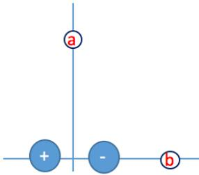
es16) Date due distribuzioni rettilinee indefinite con densità di carica  $\lambda_1 = +4 \mu\text{C}/\text{m}$  e  $\lambda_2 = -4 \mu\text{C}/\text{m}$  poste parallelamente a distanza  $2\delta = 2 \text{ cm}$ , determinare il campo elettrico:
