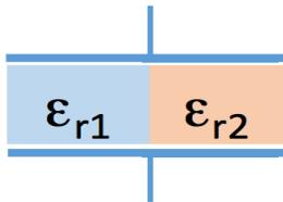
5.15) Un condensatore a facce piane e parallele ha nel vuoto una capacità  $C_0 = 10 \text{ nF}$ . Viene riempito per metà volume con un dielettrico di costante relativa  $\epsilon_{r1} = 1,4$  e per l'altra metà con un dielettrico di costante  $\epsilon_{r2} = 1,6$ . Calcolare il nuovo valore della capacità  $C$  e il rapporto fra le cariche di polarizzazione sui due dielettrici.
