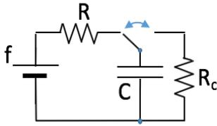
**7.12)** Gli elementi essenziali della sezione analogica del circuito di un pacemaker sono riportati nello schema in figura. Un sistema di controllo agisce sul deviatore in base alla necessità di stimolare con una scarica di  $25 \mu\text{J}$  il muscolo cardiaco che presenta una resistenza  $R_c = 500 \Omega$ .
