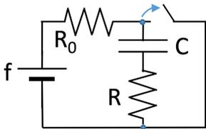
7.7) Il circuito in figura ( $R_0 = R = 1 \text{ k}\Omega$ ) è a regime quando, all'istante  $t = 0$ , l'interruttore viene aperto. Calcolare dopo quanto tempo la tensione ai capi della resistenza R è uguale alla tensione ai capi del condensatore  $C = 5 \text{ nF}$ .
