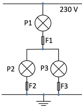
Vengono inserite nel circuito in figura in cui sono protette con fusibili tarati per intervenire (interrompere il circuito) se attraversati da correnti superiori a:  $F_1 = 4,3 \text{ A}$ ;  $F_2 = 3,2 \text{ A}$  e  $F_3 = 0,9 \text{ A}$ . Stabilire se  $F_2$  resta intatto.
