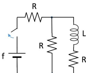
11.5) Il circuito in figura è a regime quando, al tempo  $t = 0$ , viene aperto l'interruttore. Calcolare la differenza di potenziale ai capi dell'induttanza al tempo  $t^* = 60 \mu\text{s}$ .
