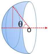
es2) Su una semisfera di raggio  $R = 10$  cm centrata nell'origine è distribuita una densità di carica  $\sigma(\theta) = \sigma_0 \cos(\theta)$  con  $\sigma_0 = 10$  nC/m<sup>2</sup>. Una carica puntiforme  $q = 1$  nC è ferma nell'origine. Determinare l'energia cinetica che acquista allontanandosi infinitamente dalla semisfera.
