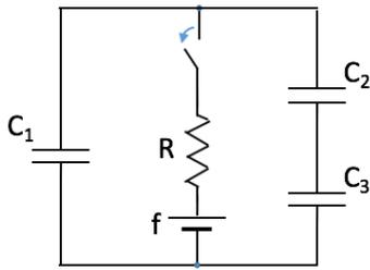
6.8) I tre condensatori del circuito in figura, costituiti da armature piane parallele della stessa superficie poste nel vuoto alla stessa distanza, hanno capacità  $C = 1 \text{ nF}$ .
