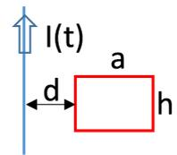
>>> soluzione:  $I_{ind} = \mu_0 k h / (2\pi R) \ln(1+a/d)$  antiorario;  $F_x = \mu_0 I(t) I_{ind} h a / [2\pi d(d+a)]$  verso destra
