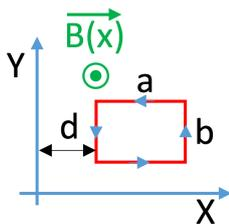
8.4) Una spira rettangolare di lati a e b è posta nel piano XY a distanza d dall'asse Y. La spira, percorsa dalla corrente I circolante in senso antiorario è immersa in un campo magnetico diretto lungo l'asse z con  $B_z(x,y,z) = Kx$ .
