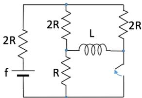
11.2) Determinare, per le due posizioni dell'interruttore, il valore dell'energia accumulata nell'induttanza in condizioni stazionarie
