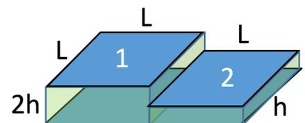
a) l'energia elettrostatica accumulata nel sistema di condensatori sapendo che sull'armatura inferiore è presente una carica  $Q = - 10$  nC;
