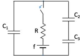
Quando il sistema è in equilibrio viene aperto l'interruttore. Raggiunta la nuova condizione di equilibrio il condensatore  $C_2$  viene riempito completamente di isolante ( $\epsilon_r = 4$ ).
