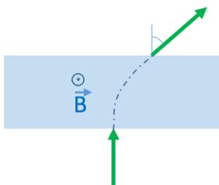
8.9) Un protone ( $m = 1,7 \cdot 10^{-27}$  kg;  $q = 1,6 \cdot 10^{-19}$  C) entra perpendicolarmente con velocità pari a  $c/10$  in una regione di spazio profonda  $d = 10$  cm in cui incontra un campo magnetico uniforme  $B = 1$  T perpendicolare alla traiettoria d'ingresso. Determinare l'angolo fra la traiettoria in ingresso e quella in uscita.
