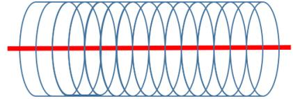
Determinare il valore di  $I$  per cui il campo  $B$  sulla superficie interna del solenoide forma un angolo di  $45^\circ$  rispetto all'asse.
