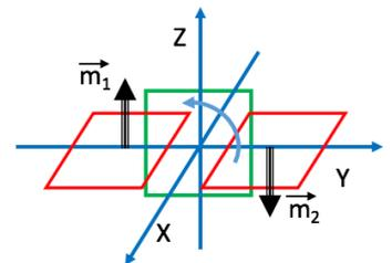
Calcolare la circuitazione del campo magnetico lungo **la linea quadrata** di lato  $L$  orientata come in figura, centrata nell'origine e giacente nel piano  $x = 0$ .
