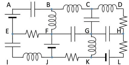
11.9) Il circuito in figura è a regime quando, al tempo  $t = 0$ , viene aperto l'interruttore. Calcolare la differenza di potenziale  $V_A - V_B$  per  $t < 0$ .
