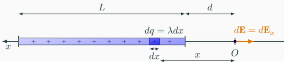
Ogni elemento  $dx$  a distanza  $x$  da  $O$  possiede una carica infinitesima  $dq = \lambda dx = q/L dx$  e genererà nel punto  $O$  un campo elettrico  $d\mathbf{E}_x$  diretto come in figura e di modulo
