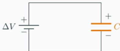
**Circuito elettrico:** un percorso chiuso formato da conduttori (fili) che collegano condensatori o altri dispositivi, nei quali la carica può muoversi, e che può includere una sorgente di tensione.
