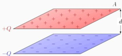
Spesso le lastre vengono arrotolate a formare un cilindro e fra esse, per garantire la separazione, viene posta della carta o altro materiale isolante.
