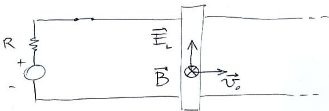
$$f_L = v_0 B e = f \Rightarrow v_0 = \frac{f}{Be}$$
