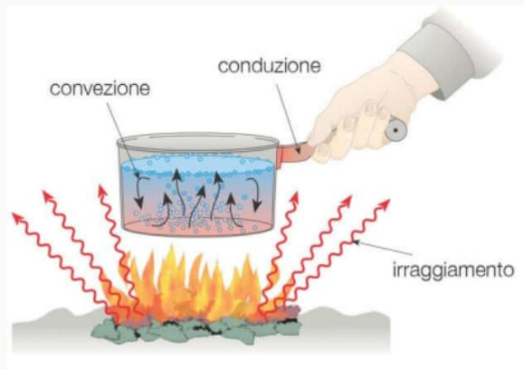
La trasmissione del calore per **conduzione** avviene in un mezzo solido, liquido o gassoso **dalle zone a temperatura maggiore verso quelle con temperatura minore**, all'interno di un corpo o tra due corpi in contatto **senza spostamento di materia**.
