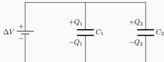
Dopo il ricollegamento, al raggiungimento dell'equilibrio elettrostatico, ai capi dei condensatori c'è la stessa differenza di potenziale  $\Delta V' \neq \Delta V$  perché diversa sarà la carica sulle armature.
