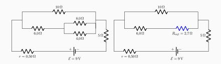
$$\frac{1}{R_{\rm eq1}} = \frac{1}{8,0\,\Omega} + \frac{1}{4,0\,\Omega} = \frac{3}{8\,\Omega} \quad \Rightarrow \quad R_{\rm eq1} = 2,7\,\Omega. \label{eq:Req1}$$
