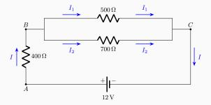
La corrente che scorre nelle due resistenze da 500 e  $700\,\Omega$  non è la stessa. Le due resistenze hanno la medesima differenza di potenziale ai loro capi  $(V_B-V_C)$  ma, per la legge di Ohm, avendo resistenza diversa, sono percorse da correnti diverse. Ovviamente deve essere
