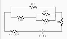
Come nell'esercizio precedente, per rispondere alla prima domanda è necessario semplificare il circuito riducendo l'insieme delle resistenze a un'unica resistenza equivalente  $R_{\rm eq}$ .
