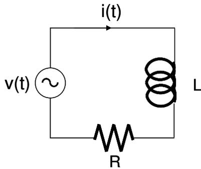
Nei circuiti RL serie l'impedenza complessa equivalente è la serie di quella del resistore e di quella dell'induttore:
