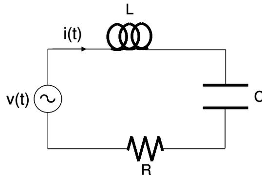
Nei circuiti RLC serie l'impedenza complessa equivalente è la serie di quella del resistore e di quella del condensatore e dell'induttore:
