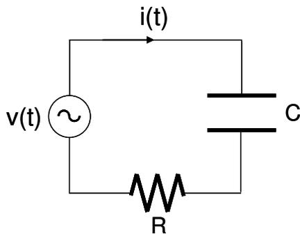
Nei circuiti RC serie l'impedenza complessa equivalente è la serie di quella del resistore e di quella del condensatore:
